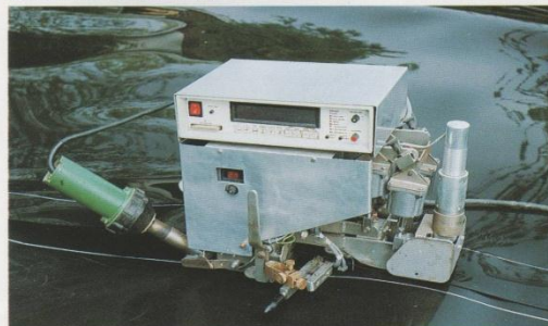
Máquina de soldadura con cuña caliente con control electrónico
